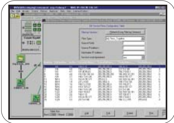
Система сетевого управления (NMS) для управления и мониторинга всеми устройствами Optical Access, включая семейства OptiSwitch, TereScope и LambdaDriver
